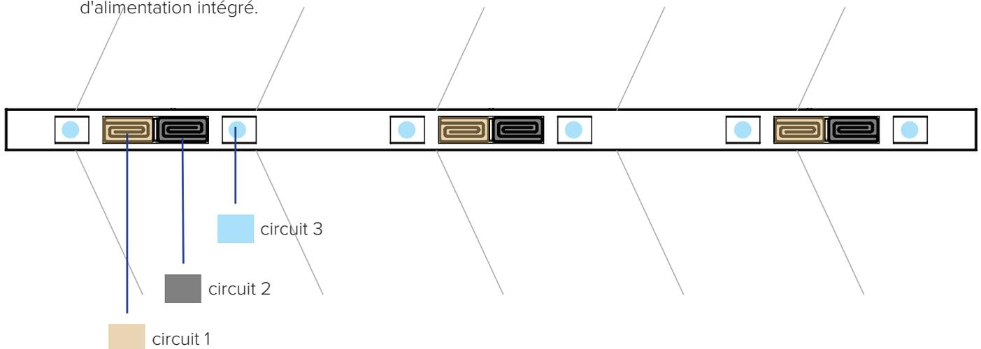
**Pour connecter le LEAF à l'alimentation principale, vous devez disposer d'une connexion à trois pôles composée d'un fil neutre et d'un fil de signal (avec une sortie de 230V AC-50 Hz) et d'un fil de mise à la terre d'un diamètre minimal de 1,5 mm<sup>2</sup> / 16 AWG. Pour des raisons de sécurité il est recommandé d'utiliser du 2,5 mm<sup>2</sup>.**
